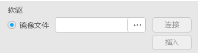
图5-71 通过虚拟软驱挂载镜像文件
