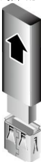
图 8-147 拆卸 USB 移动 U 盘
