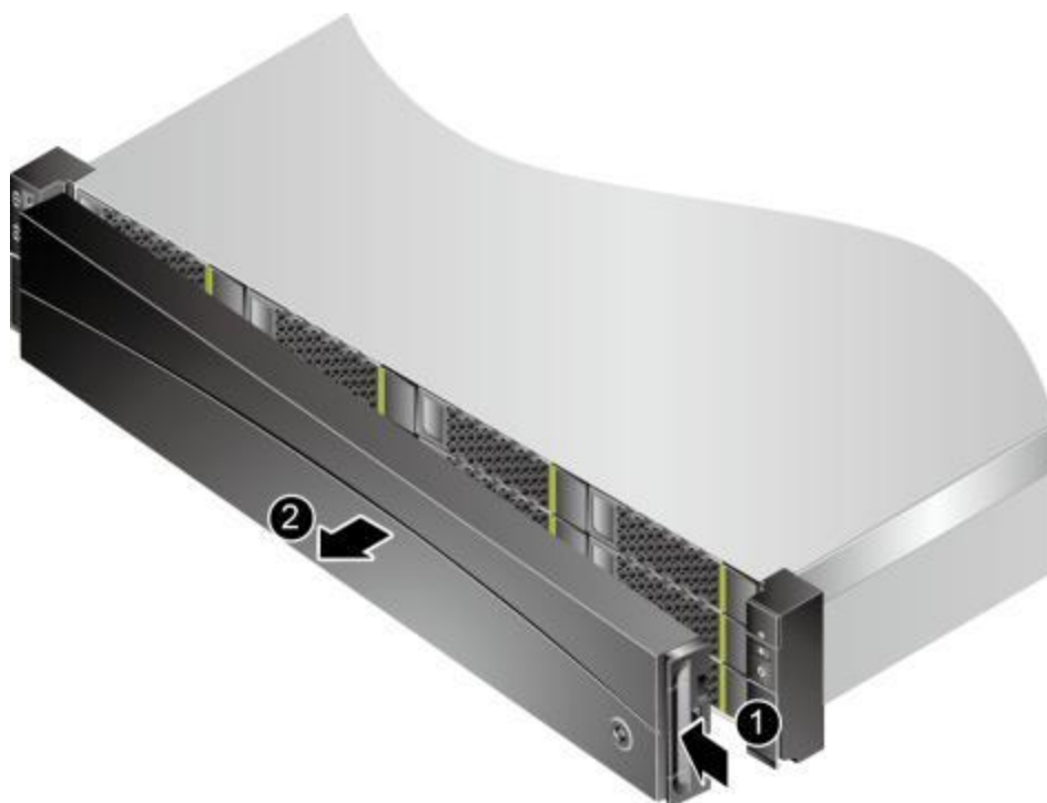
图 8-177 拆卸安全面板
