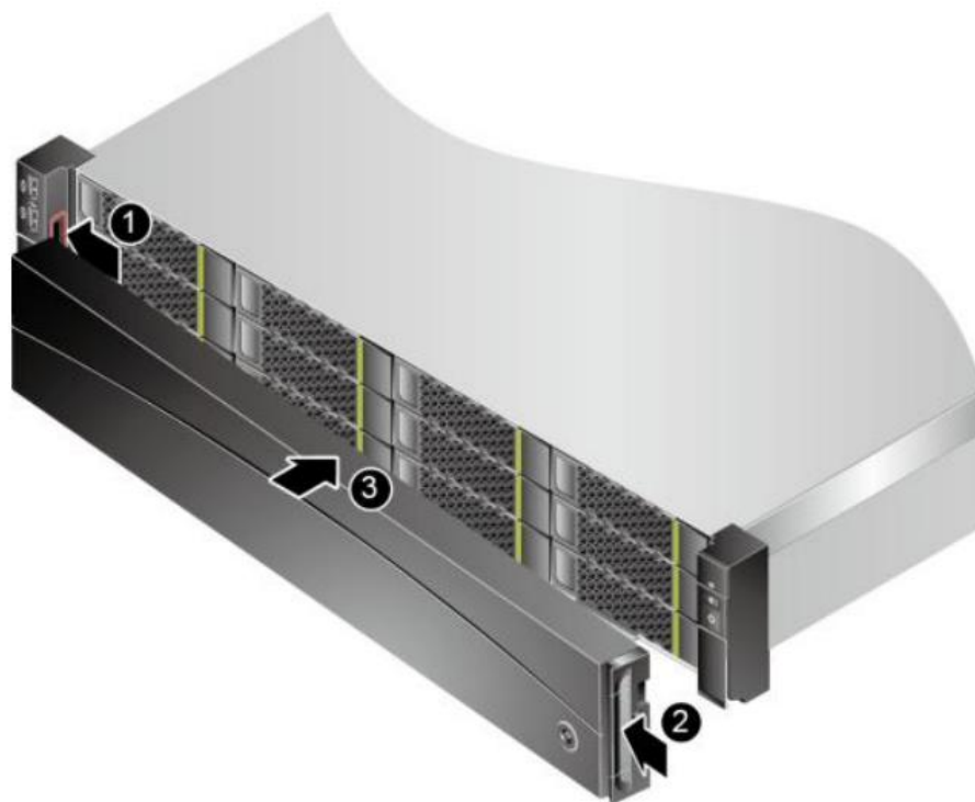
图 8-178 安装安全面板
