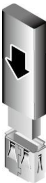
图 8-150 安装 USB移动 U 盘
