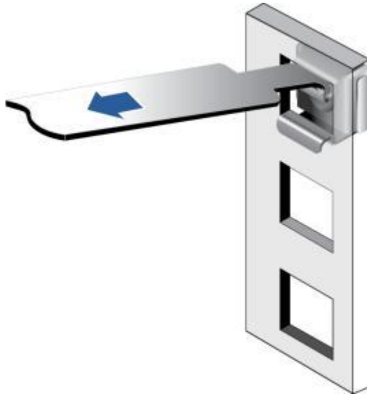
图 8-15 在机柜中安装浮动螺母
