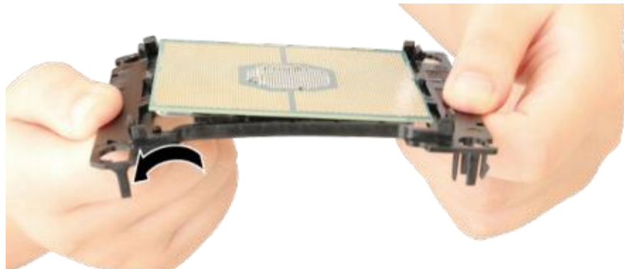
图 8-97 安装处理器另一端
